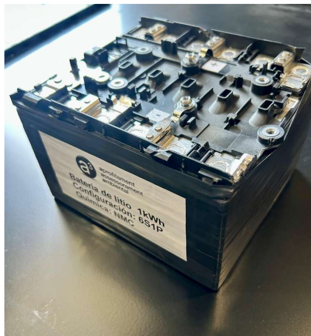
Figura 10: Batería de 1kWh para el ensayo del extintor de 6L.
